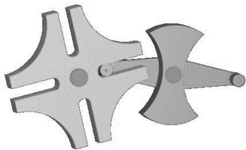
图 15 外槽轮机构 ( z=4, k=2 )
