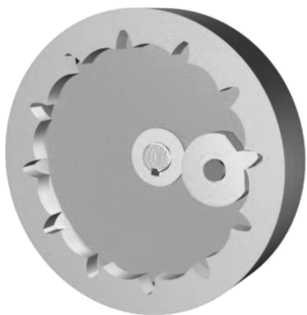
图 20 内啮合式不完全齿轮机构
